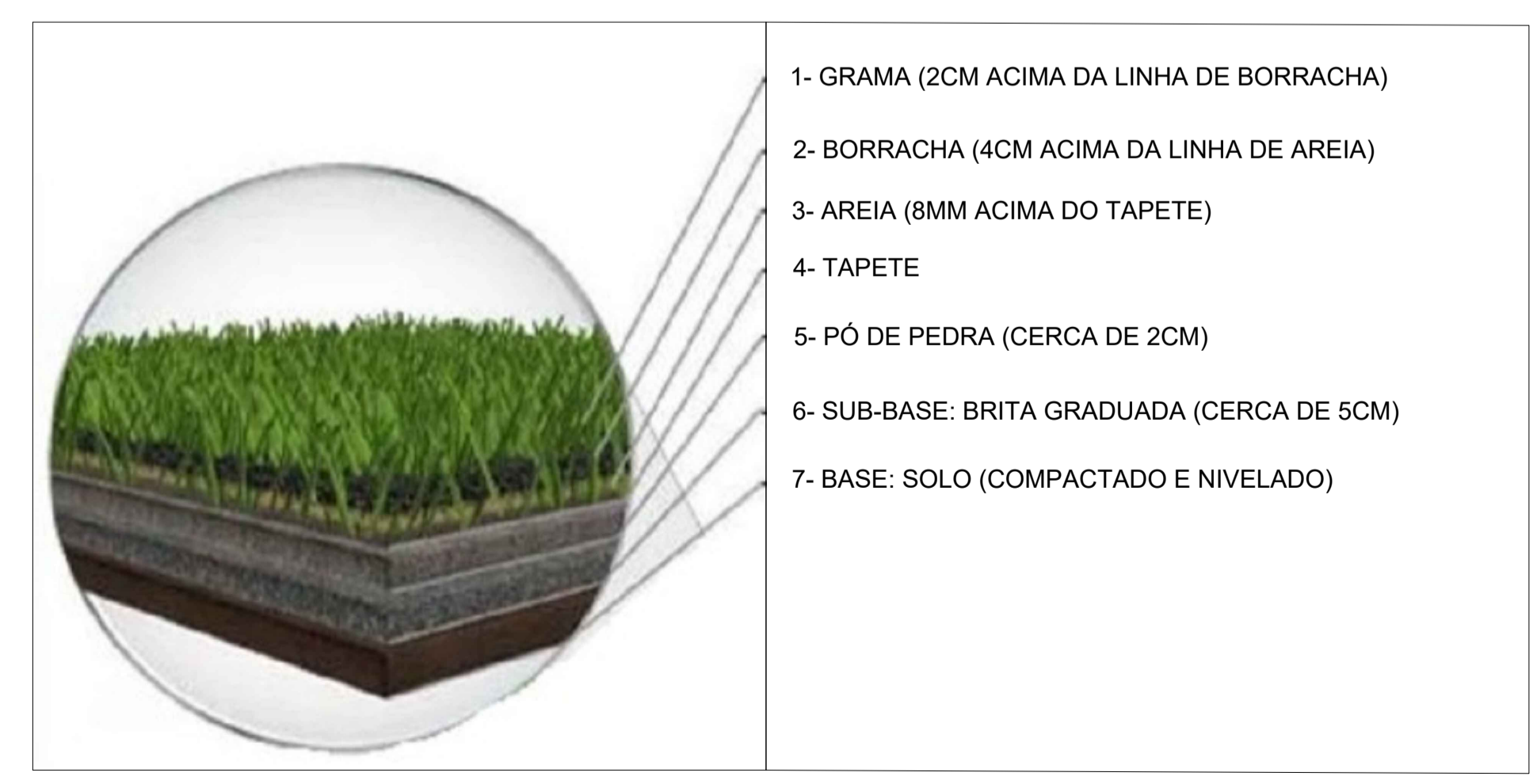
CORTE ESQUEMÁTICO - GRAMA SINTÉTICA SEM ESCALA
