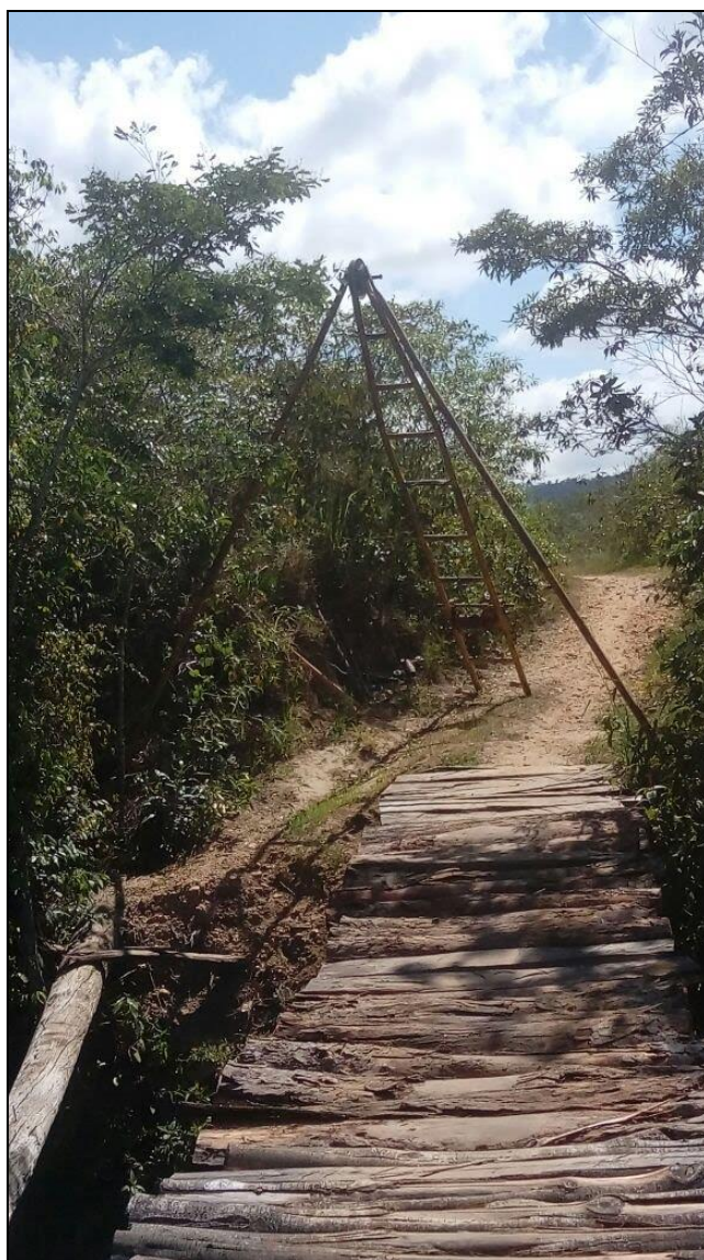
Execução do furo SPT 04
